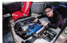
ハイエースにトヨタ2JZの3000ccエンジン積み替えます!! おそろべしアウトバーン…強化ATにタービン、インタークーラーまでスタンバイ済みとか。ゆくゆくは600馬力コースって…スコ過ぎ!!
